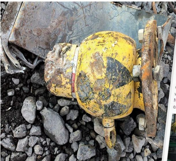
Fig. 10 : Découverte d'une source radioactive de cobalt dans la ferraille
